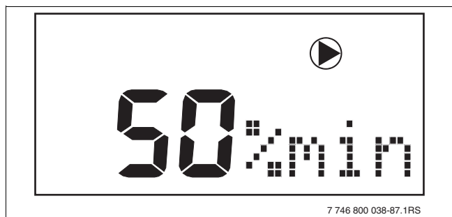
50. ábra „Szivattyú-moduláció” display-kijelzés
